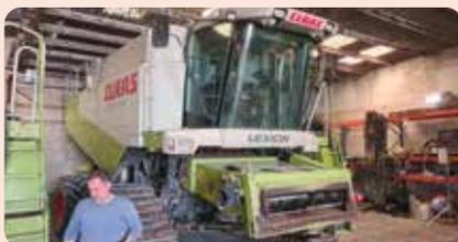
LA UNIÓ continua amb tasques d'innovació en projecte StrawMat. Acobla a una recol·lectora d'arròs convencional eines perquè pugui envasar palla d'arròs alhora que recol·lecta el cereal. Permetrà tindre palla independentment de les condicions climatològiques.
